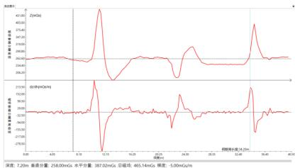
上图所述图片显示的范围为 0-40m 的曲线,通过判断得到实际钢筋笼长度 34.2m, 点击"标注"后,虚线变为实线,显示"钢筋笼长度: 34.2m"。
