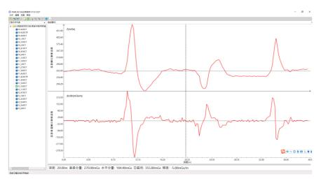
图像区域上方显示深度-磁场垂直分量曲线,下方显示深度-磁场垂直分量梯度曲线,虚线为判断钢筋笼长度标注光标。
